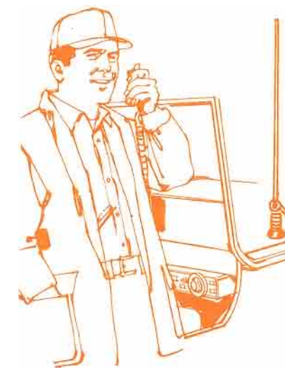
Fig. 8 - Gli autoveicoli, a causa del continuo strofinio della carrozzeria con l'aria, rappresentano, per le apparecchiature ricetrasmittenti, un pericoloso ricettacolo di cariche elettriche.
